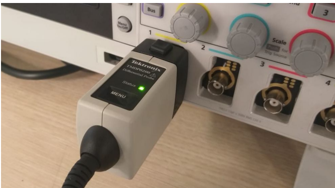
TekVPI 프로브는 스케일 설정과 범위, 상태를 TBS2000B 에 전달합니다.
