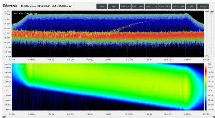
위는 DataVu-PC에 표시된 99 % 오버랩 스펙트로 그램 디스플레이와 결합 된 컬러 그레이딩 스펙트럼 디스플레이입니다. 데이터의 완전한 시각화를 위해 스트리밍 파일의 속도와 세부 사항을 변경하기 위한 전체 오버랩 / 스킵 제어 기능이 있습니다.
