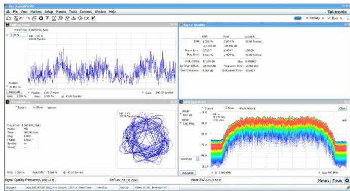
위 그림에서 500 MSymbols / sec pi / 4-QPSK로 변조 된 5GHz 캐리어는 RSA7100A 옵션 B800 및 SignalVu-PC 애플리케이션 라이센스 SVMH로 분석되었습니다. DPX 스펙트럼의 지속적인 모니터링과 함께 측정 요약, EVM 대 시간 및 성좌 표시가 표시됩니다.
