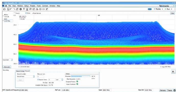
버튼을 누르거나 트리거가 수신되면 손쉬운 녹음이 가능합니다. 예상된 파일 크기가 보고되고 고품질 기록을 보장하기 위해 건너뛴 프레임 또는 과부하 상태 표시가 제공됩니다. 위의 5 초간 녹화가 진행되는 것을 볼 수 있습니다. DPX 스펙트럼은 800 MHz 수집에 대한 실시간 모니터링을 제공합니다. 파일 크기, 사용 가능한 디스크 공간, 기록 진행률, 기록 된 파일 수가 모두 보고 됩니다.
