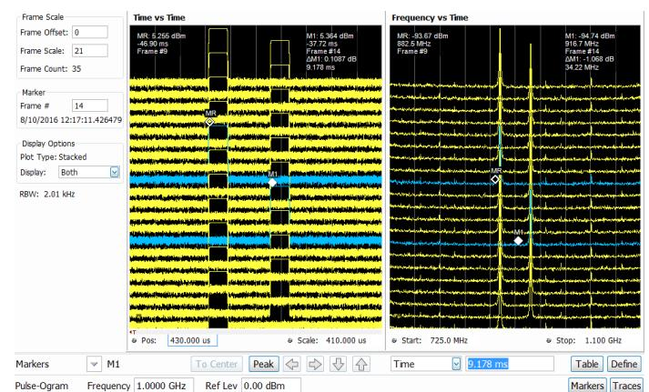
위의 그림은 SignalVu-PC 애플리케이션 라이센스 SVPF의 고유한 Pulse-Ogram 디스플레이입니다. 이것은 시간 영역에서 트리거 와의 관계를 보여주는 트리거 된 펄스의 폭포입니다. 변화는 즉시 타이밍 대 트리거의 변화로 나타납니다. 각 시간 도메인 트레이스는 시간과 주파수 도메인 효과의 즉각적인 상관 관계를 위해 디스플레이의 오른쪽에 스펙트럼으로 표시됩니다.
