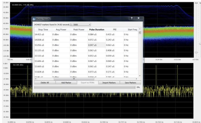
DataVu-PC 펄스 옵션은 대규모 데이터 세트에서 펄스 및 측정을 빠르게 표시합니다. 위의 펄스 검색 결과에는 시작 / 중지 시간, 평균 / 피크 전력, 펄스 지속 시간, PRI (Pulse Repetition Interval) 및 2,000,000 펄스까지의 시작 / 중지 주파수의 펄스 측정 값이 표시됩니다. 다른 도구에서 사용하기 위해 펄스 결과를 PDW 형식으로 내보낼 수 있습니다.
