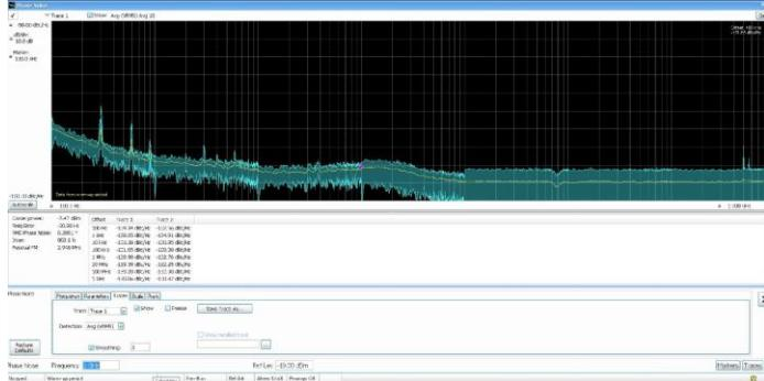
이 주파수 및 작동 범위에서 RSA7100A의 고유 위상 잡음-134dBc / Hz는 대다수의 응용 분야에서 충분한 측정 마진을 제공합니다. 애플리케이션에는 VCO 위상 노이즈, 발진기 위상 노이즈, 클럭 소스 지터, 신호 발생기 위상 노이즈 등이 포함됩니다.
