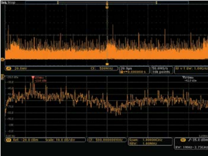
그림 12. RF 진폭 대 시간 추적은 상당한 펄스를 보여줍니다. 스펙트럼 디스플레이는 주파수 내용을 보여줍니다.
