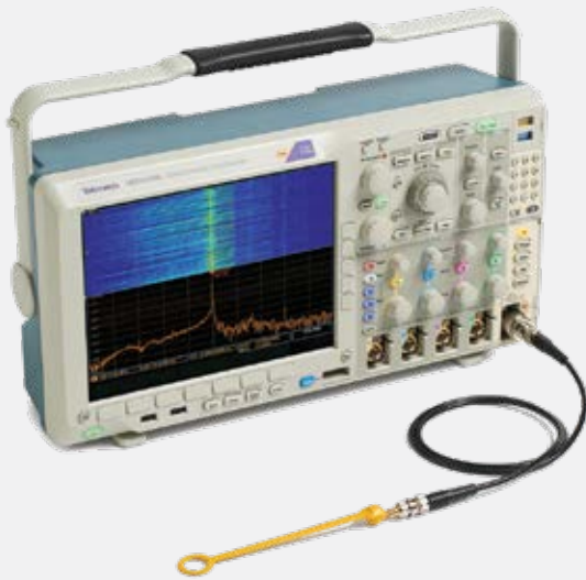
MDO4000 시리즈는 스펙트럼 분석기, 오실로스코프 및 로직 분석기를 단일 장치에 결합하여 세 가지 계측기 모두에서 시간 상관 측정을 생성합니다.
