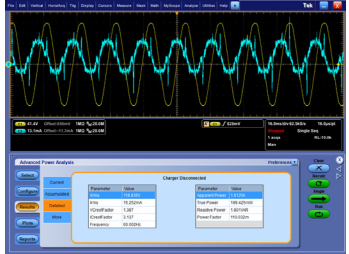
그림 13. 로드 되지 않은 랩톱 PC 전원 어댑터의 전원 품질 측정
