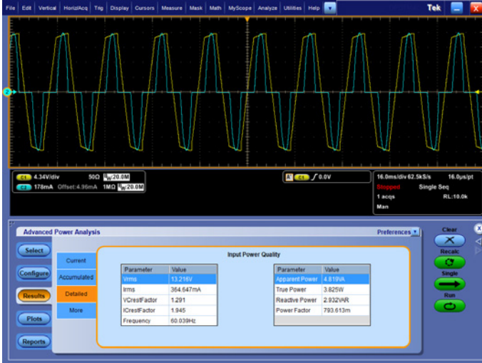
그림 8. 전압, 전류, 전력 및 에너지 판독 값
