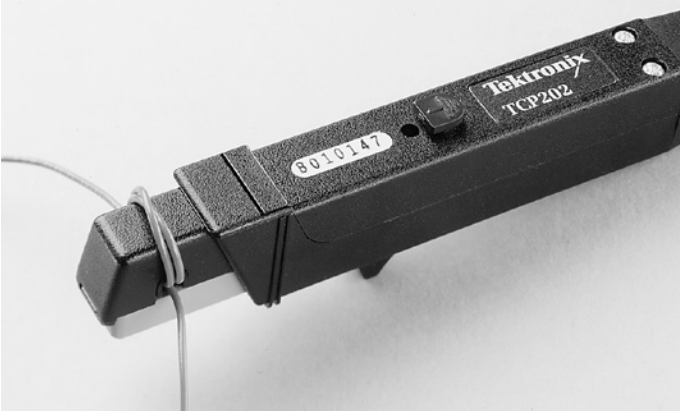
그림 5. 전류 프로브 주위에 도체의 N 회전을 감아 전류 감도를 높입니다.
