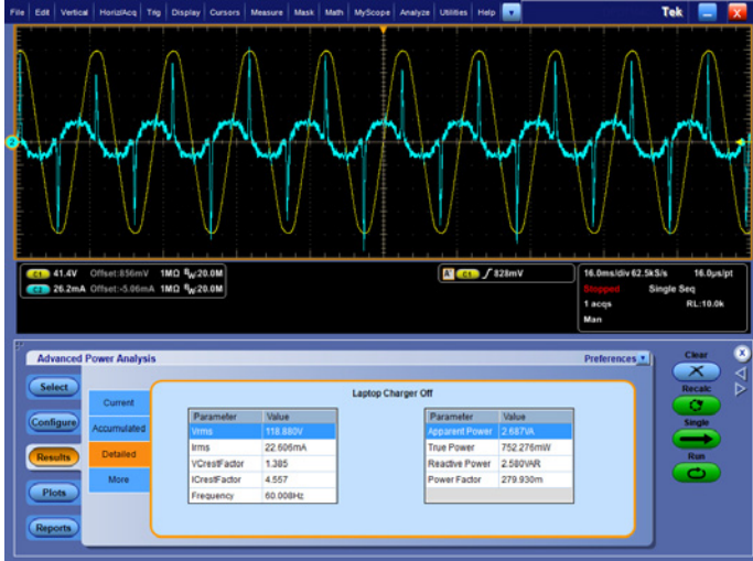
그림 12. 랩탑 배터리를 충전 한 후 랩탑을 끈 상태에서 PC 전원 어댑터의 전원 품질 측정.
