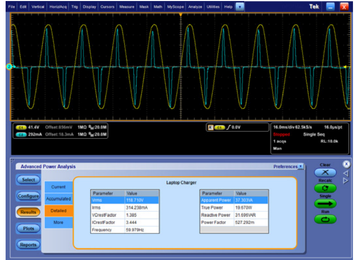
그림 11. 랩톱이 실행되는 동안 랩톱 배터리가 충전 된 후 PC 전원 어댑터의 전원 품질 측정
