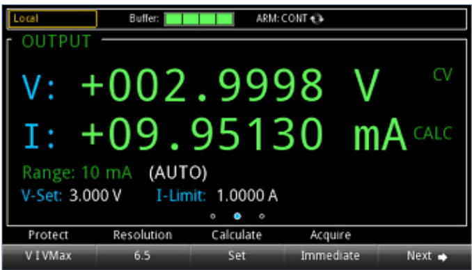
그림 3. 멀티 미터가 연결되지 않은 경우 전류 판독
