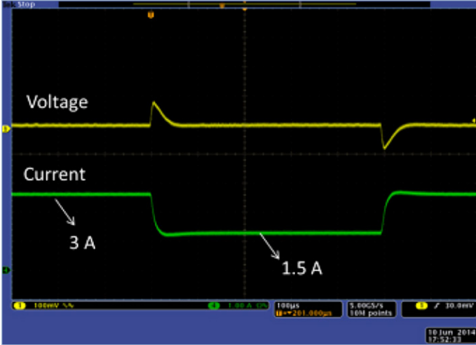
그림 7. 부하 전류가 즉시 3A에서 1.5A로 전환 된 다음 다시 3A로 전환됩니다. 출력 전압은 매우 빠른 38 us 내에서 회복
